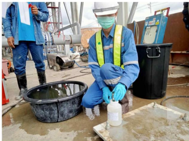
รูปที่ ง-3 รูปแสดงการตรวจวัดคุณภาพน้ำทิ้งจากการทดสอบท่อด้วยวิธีทางชลสถิต
